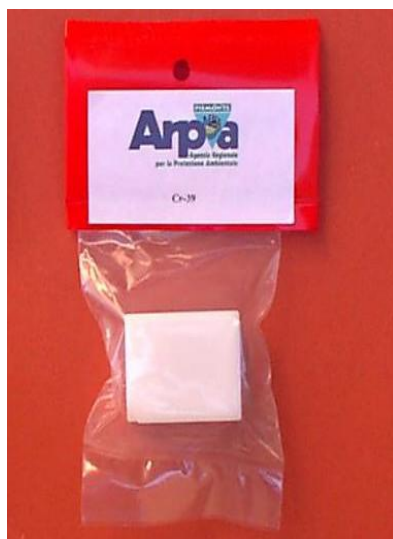
Figura A3.3 – Dosimetro ARPA Piemonte in configurazione di misura con busta di polietilene
