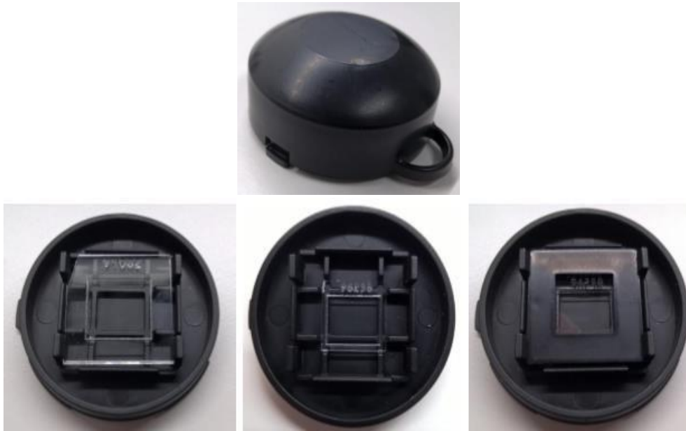
Figura A3.3 – Dosimetro Radout, pronto per la misura (chiuso) e in fase di assemblaggio: è visibile nell'alloggiamento interno il rivelatore CR-39
